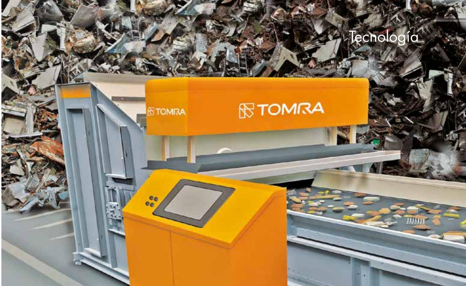
Los metales (el acero y el hierro, la electrónica, otros metales no férricos y aleaciones de aluminio) se separan; los fluidos se retiran antes de la fragmentación y, una vez triturados encontramos una gran cantidad de residuos, lo que incluye todo el residuo no metálico: vidrio, textil, goma, espuma, arena, madera y plásticos. Al menos el 50% de esta fracción contiene valioso material recuperable.
